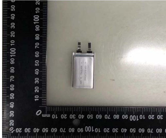
Cell / 电芯 (CF502540 3,0V 1200mAh)
